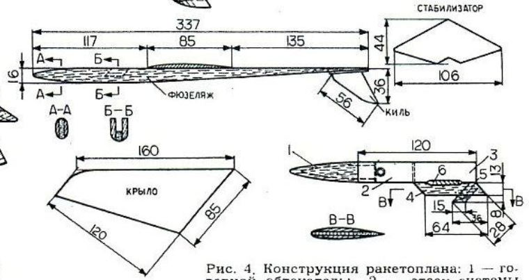
Рис. 4. Конструкция ракетоплана: 1 — головной обтекатель; 2 — отсек системы спасения; 3 — двигатель; 4 — пилон; 5 — клык; 6 — направляющая трубка.
